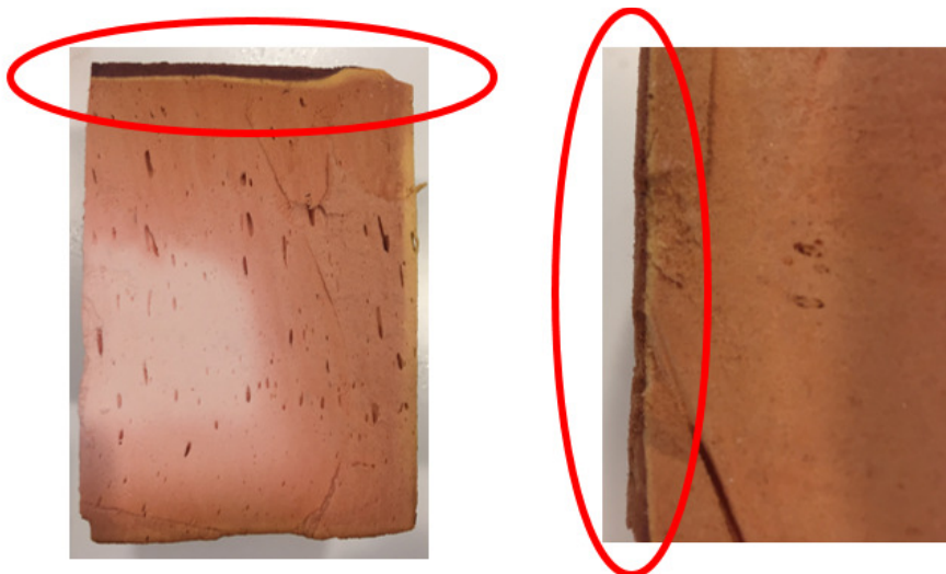
Bild 2 Tvärsnitt på isolering med missfärgad yta
